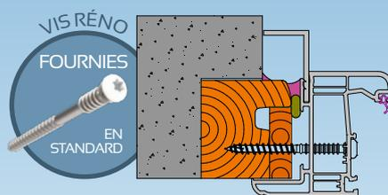
Par vis rénovation fournies en standard pour dormants aile de 27, 42 et 65 mm
