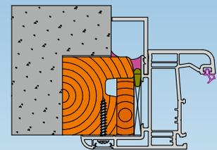
En façade par vis non fournies pour dormant aile de 42 mm
